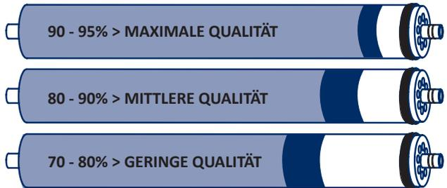
Unter 70% gilt die Lebensdauer der Membran als beendet. Vergleichen Sie die Leitfähigkeit des Leitungswassers mit der des Wassers, das durch die Membran kommt, mit einem Leitfähigkeitsmesser oder einem TDS-Messgerät. Dadurch erhalten Sie den Prozentsatz der abgewiesenen Salze.
