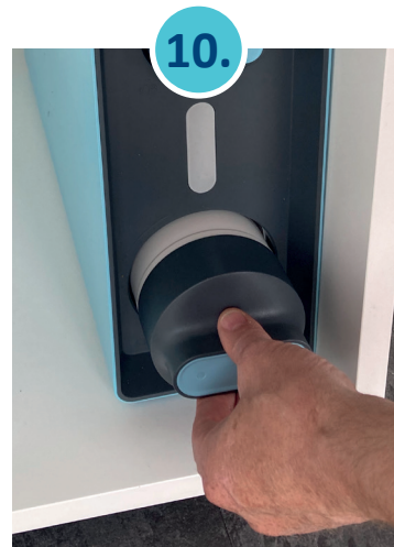
10. Neuen Vorfilter CF einsetzen und festdrehen bis er einrastet
