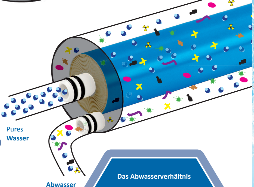
Schematische Darstellung der Membranfunktion
